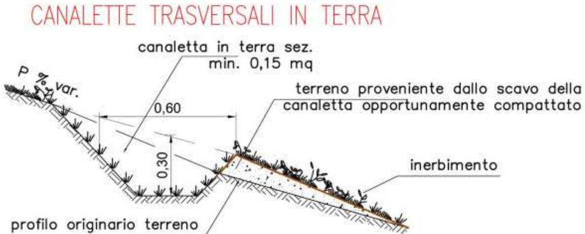
Figura 33 Schema canalette in terra
